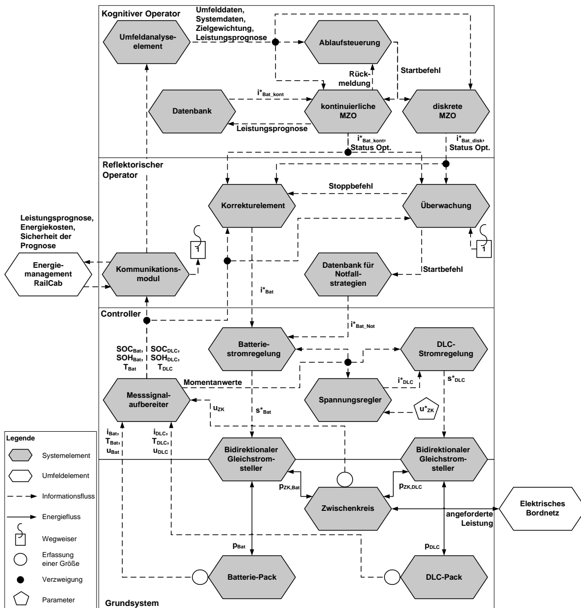
Bild 5-10: Wirkstruktur des OCM für das hybride Energiespeichersystem
