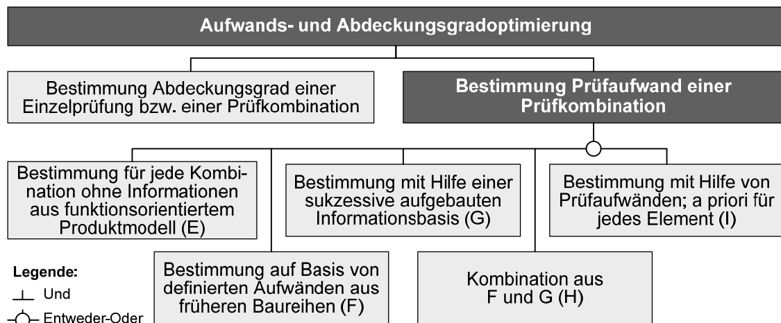
Bild 4-29: Möglichkeiten zur Bestimmung des Prüfaufwands einer Prüfkombination
