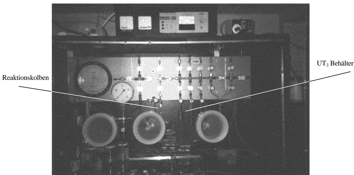
Abb. 5: Tritierungsanlage mit Reaktionskolben und UT_3 -Vorratsbehältern der Firma TriTec, St. Gallen, Schweiz.
