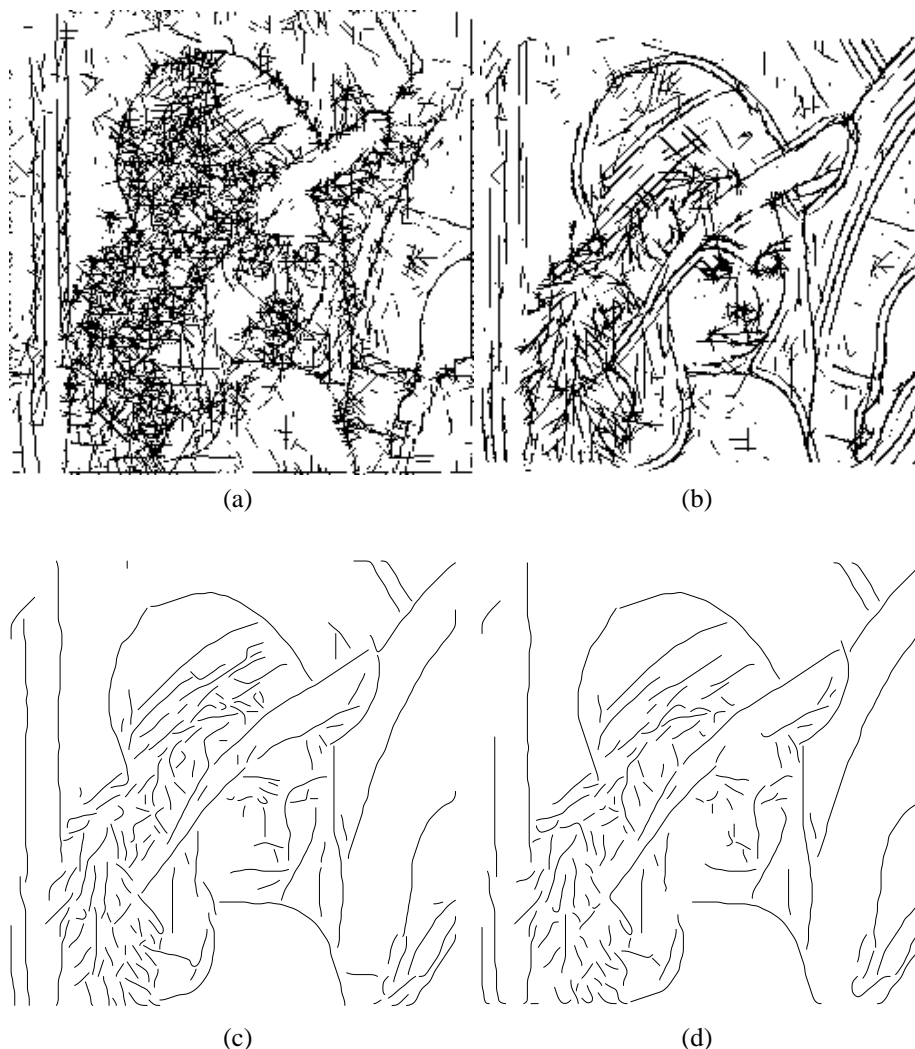
Abbildung 3.8: Konturenextraktion nach der Gabor-Filterung: Beispiel Lena. Nachverarbeitung nach der Multikanal-Gabor-Filterung und WTIA mit dem Eingangsbild von Abb. 3.7-(a) auf S. 69. Die Bilder (a) und (b) sind die jeweils vorhergehenden Ergebnisse durch den G- und M-Verdünnungsalgorithmus unterm Khoros . Das Bild (c) ist vom Algorithmus ( gradedge.sh ) durch die Kreierung einer Orientierungskarte während der Multikanal-Gabor-Filterung ( gfilt.c -t2 ), Non-Maximum-Suppression , Hysterese-Schwellenwert-Verfolgung ( pfmdir -H ) [Canny, 1983, 1986], binäre Verdünnung ( pgmthin.c ) [Zhang und Suen, 1984] [Lee und Chen, 1992] [Gonzalez, 1987, 398–402] [Guy und Medioni, 1983, 1992, 1996] und Konturenverkettung ( pgmlink.c ) gewonnen worden. Mit einem ähnlichen Verfahren ( gmedge.sh ), bis auf den Verzicht auf die vorgegebene Orientierungskarte, ist das Bild (d) konstruiert worden. Die für die Non-Maximum-Suppression notwendige Orientierungskarte wird durch die Diagonalisierung der Hesse-Matrix (v. et. Fußnote 99 auf S. 69 und pfmgauge.c -g ) des Eingangsbildes Abb. 3.7-(a) auf S. 69 nachgewonnen. Es sei darauf hingewiesen, daß die Konturen in den früheren Ergebnissen (a) und (b) nicht ein-pixel-breit sind und viel geringere Idempotenz-Eigenschaft als unsere in den Bildern (c) und (d) aufweisen. Cf. § 2.1.1 ab S. 8.
