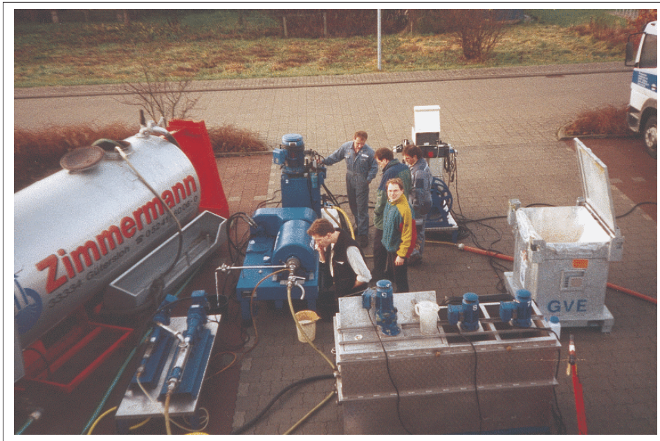
Abbildung 3.3: Versuch zur Aufbereitung von Abwässern aus der Leim- und Klebemittelproduktion im 7-m 3 -Maßstab
