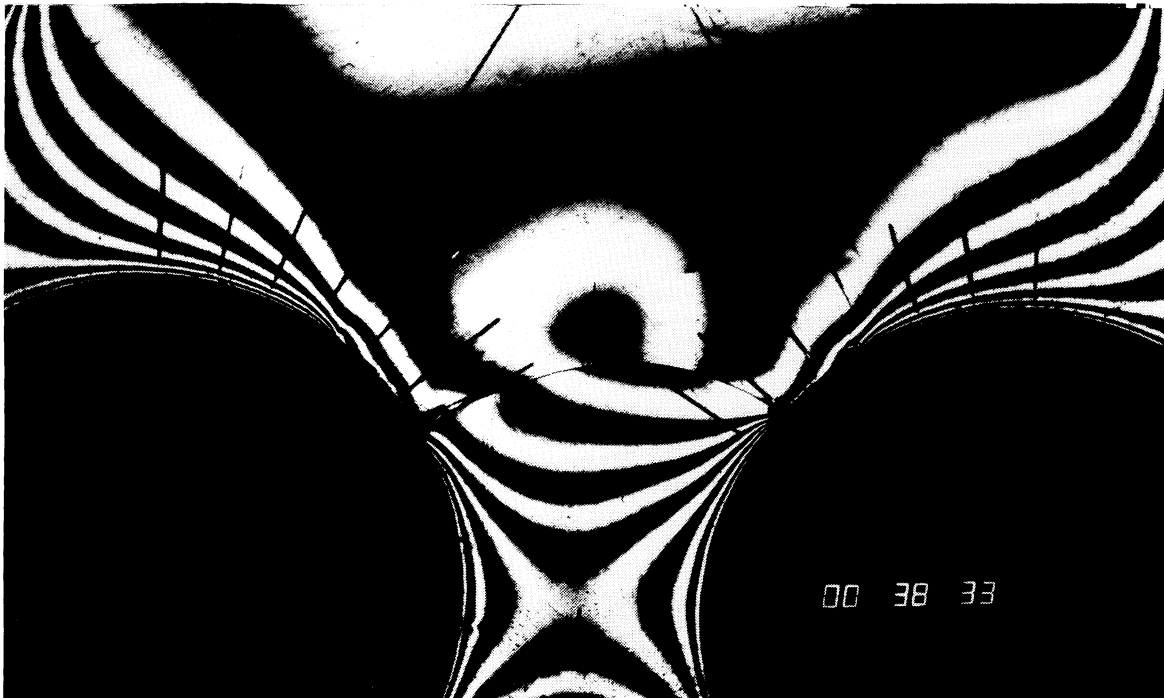
Abb. 10.30-e: Entwicklung einer Grenzflächenrißkombination
