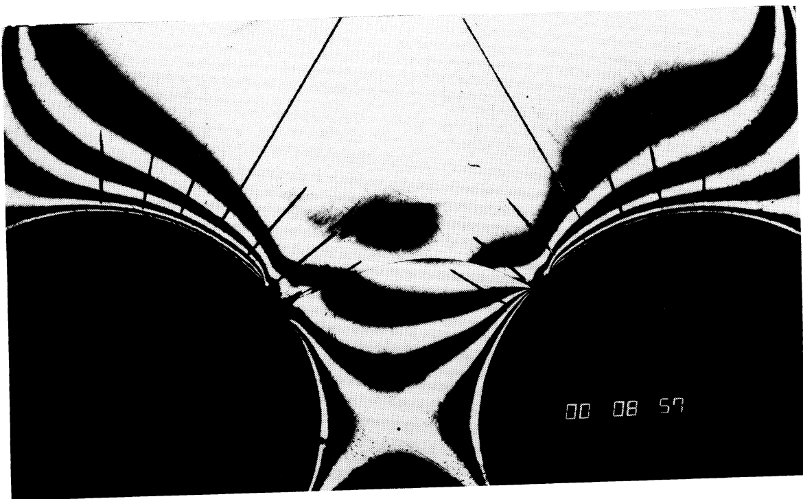
Abb. 10.30-b: Entwicklung einer Grenzflächenrißkombination
