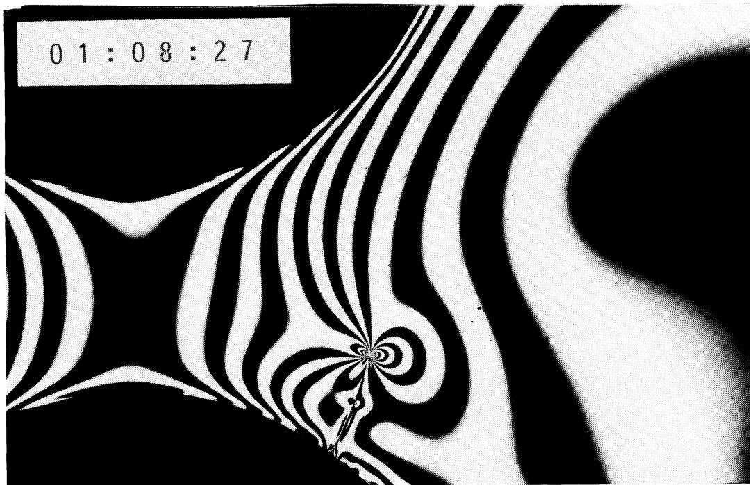
Abb. 11.3-c: Eigenspannungsriß mit der Rißlänge a=9,8 mm
