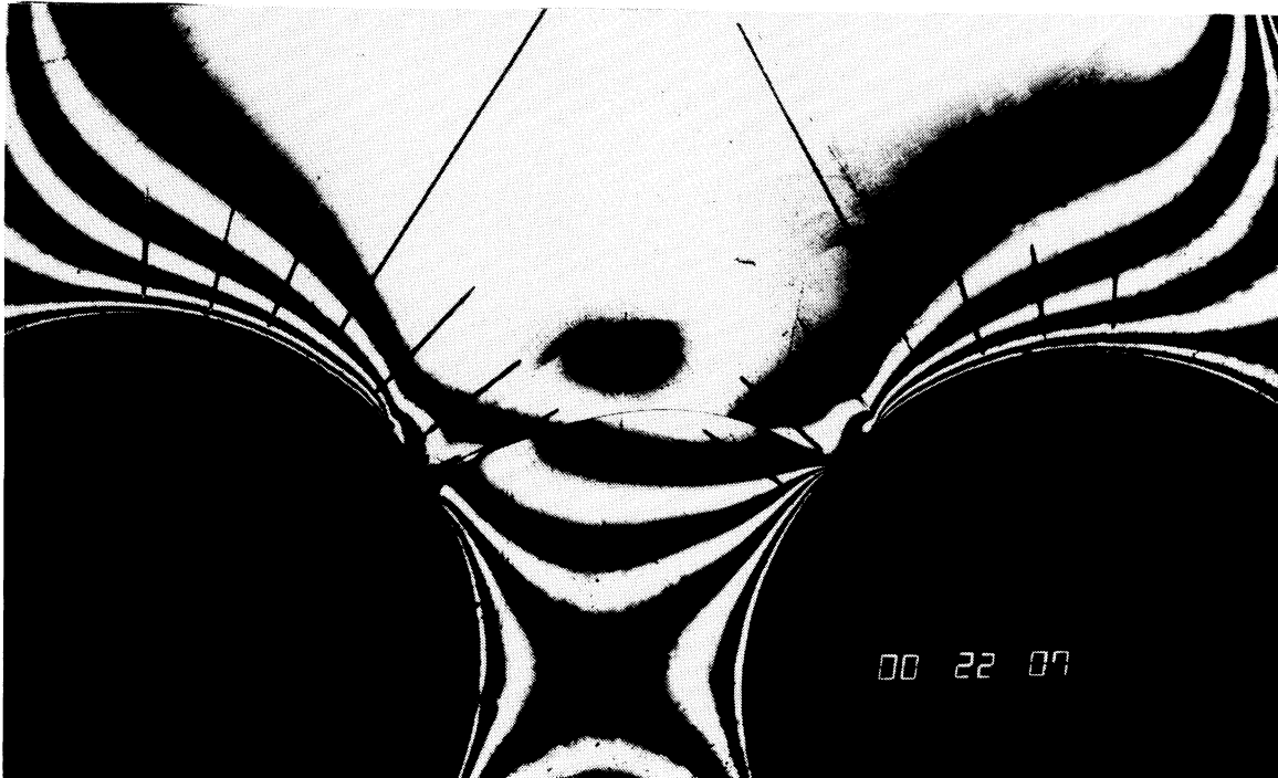
Abb. 10.30-c: Entwicklung einer Grenzflächenrißkombination
