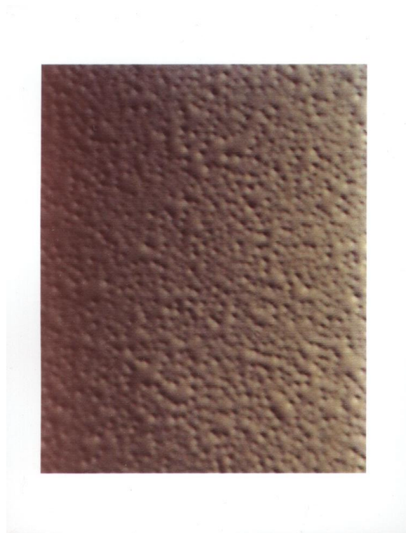
Bild 6-34 Mikroskopische Aufnahme des Pulverlackes (Aufsicht)
