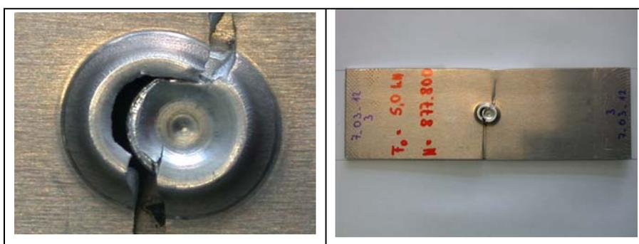
Bild A.8: Charakteristisches Versagensverhalten der Probenform IV (AlMg<sub>5</sub>Mn)
