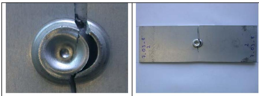
Bild A.7: Charakteristisches Versagensverhalten der Probenform IV (AlMg<sub>0,4</sub>Si<sub>1,2</sub>)
