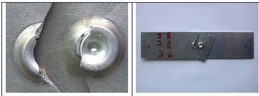
Bild A.10: Charakteristisches Versagensverhalten der Probenform V (AlMg5Mn)
