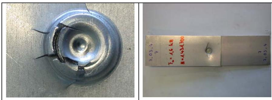
Bild A.11: Charakteristisches Versagensverhalten der Probenform V-Tef. (AlMg0,4Si1,2)
