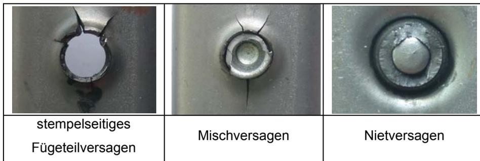
Bild 6.2b: Charakteristisches Versagensverhalten von Stahl-Stanznietverbindungen
