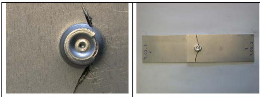
Bild A.9: Charakteristisches Versagensverhalten der Probenform V (AlMg0,4Si1,2)
