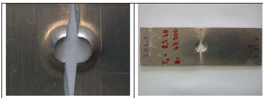
Bild A.4: Charakteristisches Versagensverhalten der Probenform II (AlMg5Mn)
