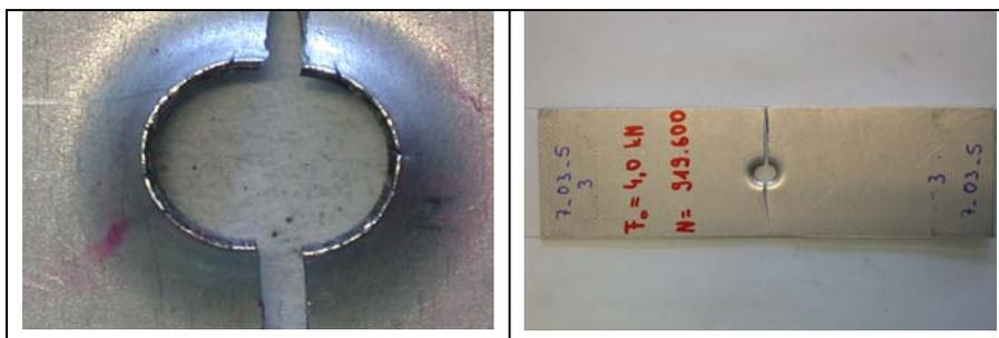
Bild A.3: Charakteristisches Versagensverhalten der Probenform II (AlMg0,4Si1,2)
