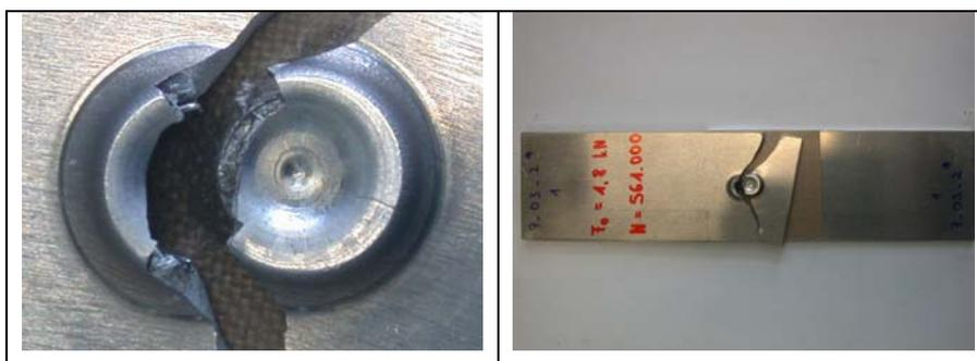
Bild A.12: Charakteristisches Versagensverhalten der Probenform V-Tef. (AlMg5Mn)
