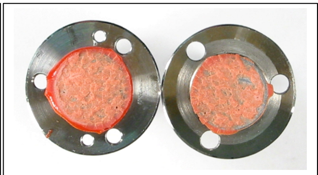
Bild 7.2.2.15: Bruchbild XD 4600 ( d_k=0,5\text{mm} / unbeh)
