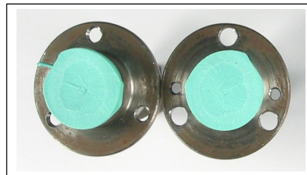
Bild 7.2.2.11: Bruchbild XB 5103 ( d_k=3,0\text{mm} / beh)
