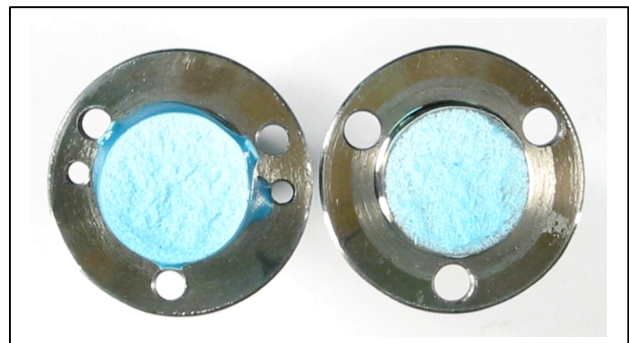
Bild 7.2.2.24: Bruchbild Betamate 1496 ( d_k=1,4\text{mm} / unbeh)
