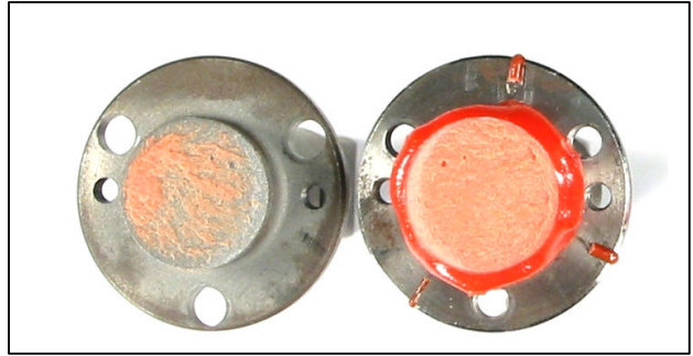
Bild 7.2.2.19: Bruchbild XD 4600 ( d_k=3,0\text{mm} / unbeh)
