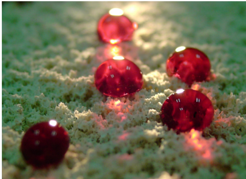
Abbildung 34: Wassertropfen auf der Oberfläche einer mit Dynasilan 6598 hydrophobierten Keramik
