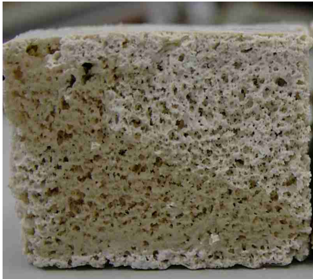
Abbildung 37: Probekörper MS10 nach dem Wasseraufnahmetest
