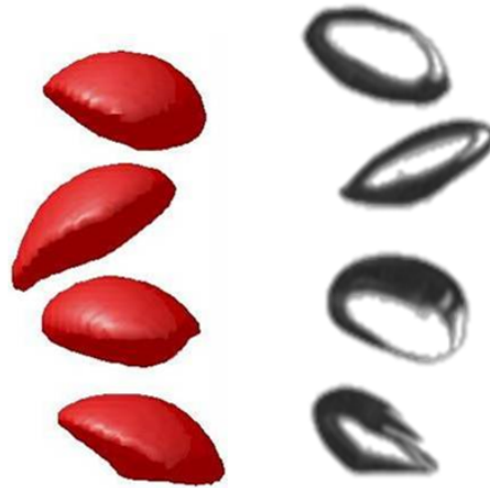
Abbildung 9.17.: Fotosequenzen einer aufsteigenden Blase mit formdynamischer Oberfläche; links: Simulation d_B = 8,0\text{mm} , rechts: Experiment d_B = 6,5\text{mm} .
