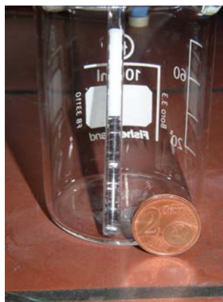
Abbildung 6.11: Fotografie eines NMR–Röhrchens gefüllt mit Scheiben aus photonischen Kristallen aus makroporösem Silizium.
