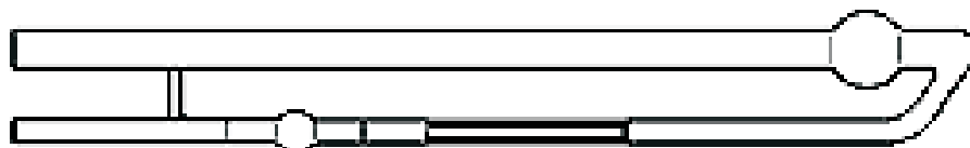
Abbildung 7.5: Schema eines um 90^\circ gedrehten OSTWALD-Viskosimeters. Die hier verwendeten Viskosimeter haben ein Durchflussvolumen von 0,5 mL (kleine Kugel) und sind mit 3 mL Probenvolumen zu befüllen (große Kugel). Die Kapillare ist ca. 10 cm lang.
