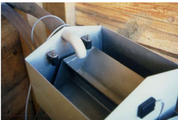
Abb. 11: 1 l-Kippwaage mit Reedkontakt
