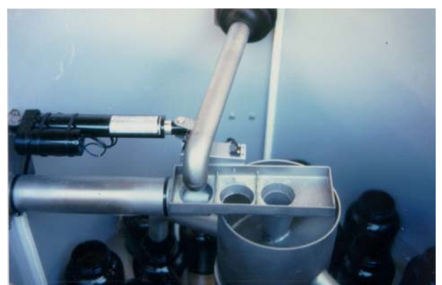
Abb. 12: Blick in den Verteiler-Behälter mit Dreh- und Schwenkantrieb sowie Probenflaschen
