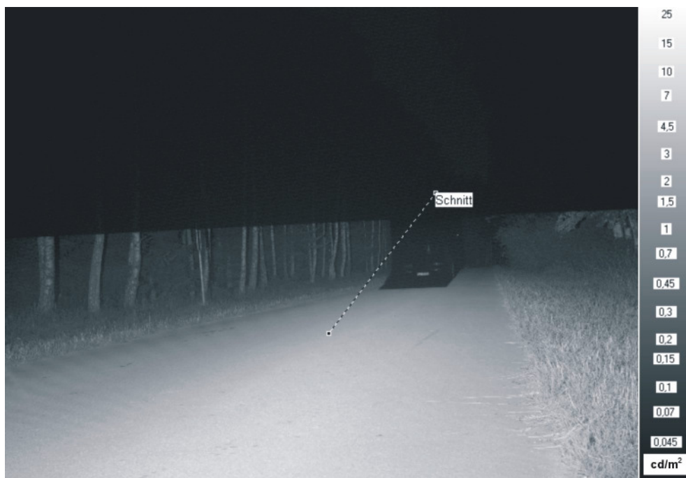
Abbildung 7.8: Leuchtdichtebild des mit dem Aktiven Licht ausgeleuchteten Fahrzeugvorfelds
