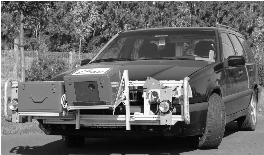
Abbildung 6.5: Versuchsfahrzeug mit dem DMD-Scheinwerfer
