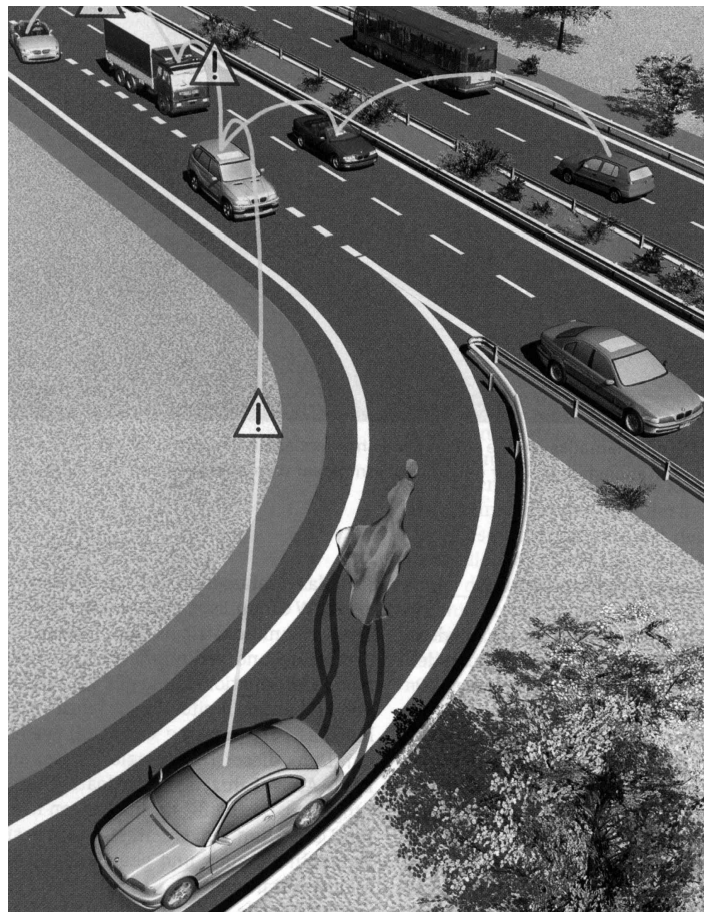
Abbildung 2.17: Informationsübermittlung über eine lokale Gefahrenstelle an nachfolgende Fahrzeuge mit Hilfe vom Ad Hoc Kommunikationsnetz (Göschel 2004)
