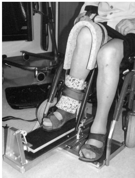
Abbildung 3-2: Zum Kraftmessgerät entwickelter und umgebauter Rollstuhl
