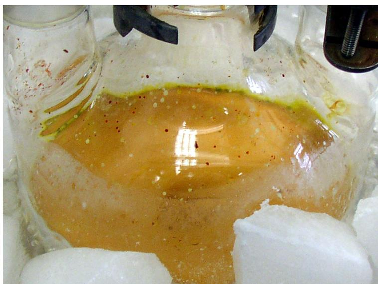
**Abbildung 57:** Endstadium der  $\text{Na}_2\text{S}_2$ -Synthese. Nach Erreichen der gelben Farbe kann das Kältebad entfernt werden, so daß Rückflußbedingungen vorliegen.
