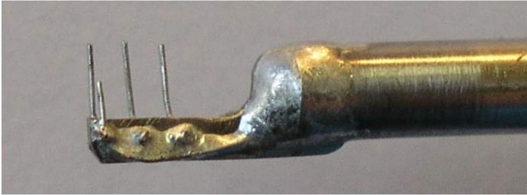
Bild 4.4: Dreifach-Temperatursensor mit Halteblech und einem zusätzlichen vierten verkürzten Thermoelement an Position 1 (Version Ib)
