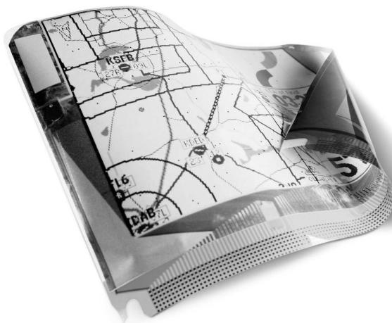
Abbildung 1.3: Gemeinsam mit OFETs als Treiberelement lassen sich OLEDs als Pixel-Bausteine in aufrollbaren Displays auf einem flexiblen Substrat integrieren
