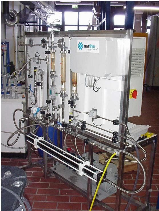
**Abbildung 7.2:** Nanofiltrations-Versuchsanlage der Fa. AMAFILTER GmbH
