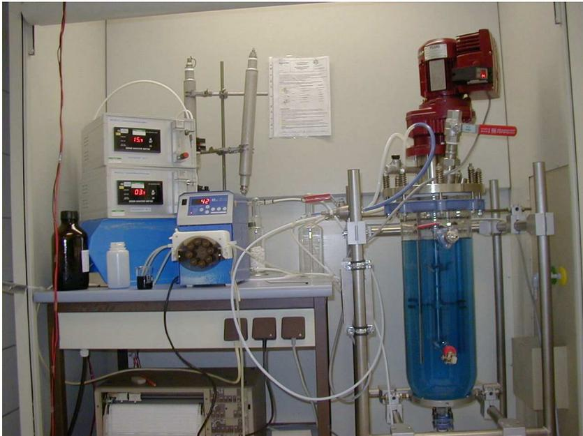
Abbildung 9.17: Versuchsanlage zur satzweisen Ozonierung bei kürzeren Reaktionszeiten
