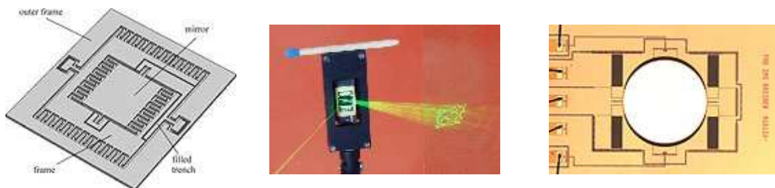
Abbildung 5.17: Mikromechanische Scanner-Spiegel (1D und 2D) [8.2, FRAUNHOFER IPMS, 2003-2]
