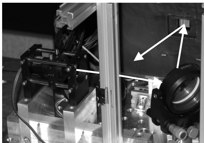
Abbildung 6.13: Vibrationsuntersuchung mit einem Laser, mit dem Umlenkspiegel der Einkopplung und dem DMD-Ständer (ohne Einkopplung und ohne Auskopplung)
