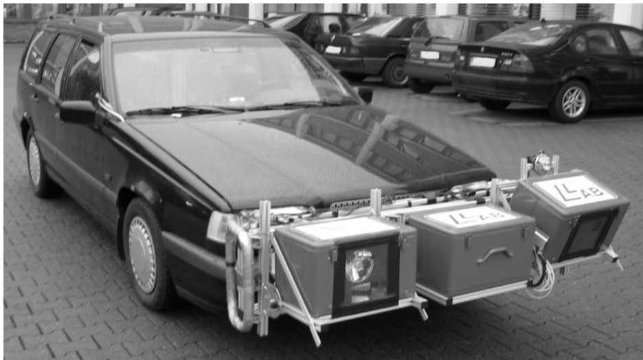
Abbildung 6.1: Versuchsfahrzeug mit Frontreck, an dem der scannende Scheinwerfer (links) und der DMD-Scheinwerfer (Mitte und rechts) montiert sind.
