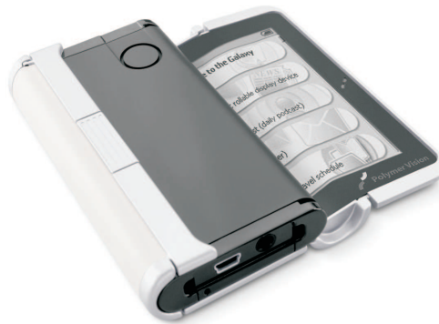
Abbildung 1.1: Anwendungsbeispiel für gedruckte Elektronik: Ein aufrollbares Display in einem Handy [1].
