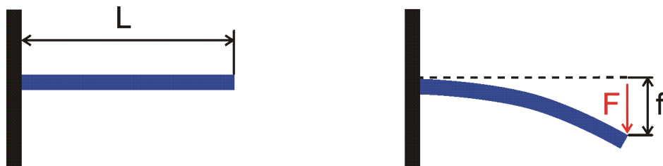
Abbildung 34: Biegeversuch an einem homogenen Träger
