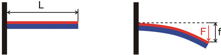
Abbildung 35: Biegeversuch an einem heterogenen Träger
