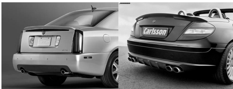
Abbildung 4-42 Rückleuchten mit geringer horizontaler bzw. vertikaler Ausdehnung
