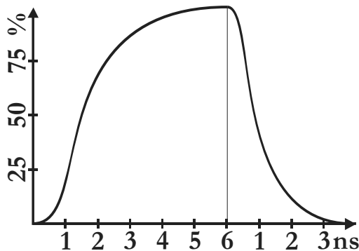
Abbildung 2-39 Schaltzeiten einer RCLED bei T=300\text{K} ; die Unterschiede zwischen \tau_{\text{rise}} und \tau_{\text{fall}} basieren auf dem Ladungsträger sweep-out aus der aktiven Zone [Schu06]
