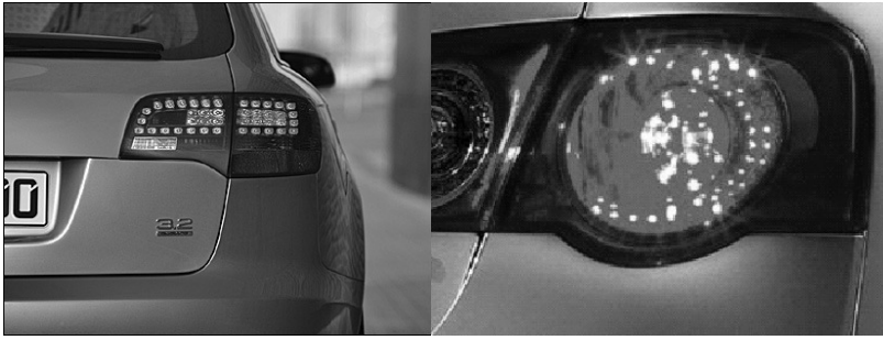
Abbildung 4-43 Rückleuchte mit visuell auflösbaren Einzellichtquellen
