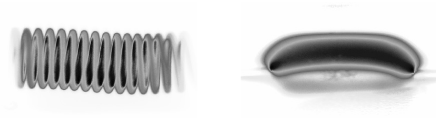
Abbildung 2-8 Aufnahme einer H7-Glühwendel und eines D2-Lichtbogens im gleichen Maßstab. Hohe Leuchtdichten sind mit dunklen, niedrige mit hellen Graustufen dargestellt.
