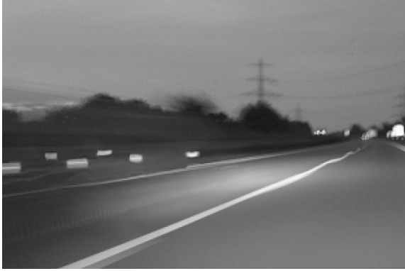
Abbildung 3-9 Perlschnureffekt bei gepulstem Rücklicht
