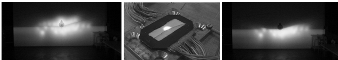
Abbildung 3-5 Frei adressierbare Lichtquelle (Mitte) Projektion einer Fernlichtfunktion (links) Projektion einer Abblendlichtfunktion (rechts)
