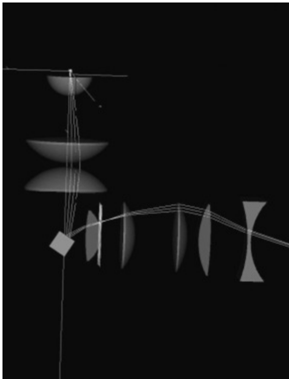
Abbildung 5-9 Optisches System des Funktionsmusters
