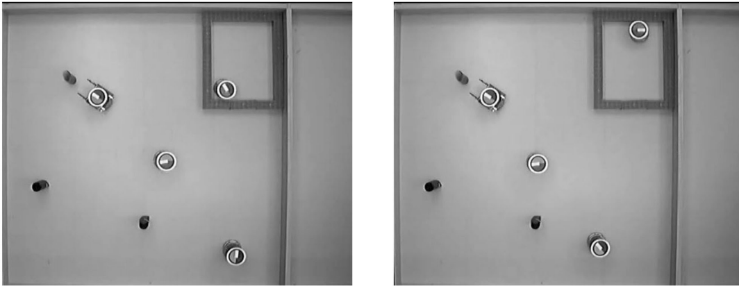
Abbildung 6-9. Der Patrouillenroboter fährt wieder. Nun wird der zweite Kameraroboter unten rechts aktiviert.
