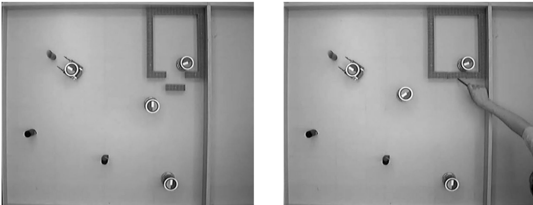
Abbildung 6-8. Der Patrouillenroboter ruft seinerseits nun den Kameraroboter zu Hilfe, um die Situation zu bewerten. Diesmal ist der Kameraroboter der Dienstleister. Danach sucht der Kameraroboter weiter nach Zylindern. Das Loch in der Wand wird von außen geschlossen.
