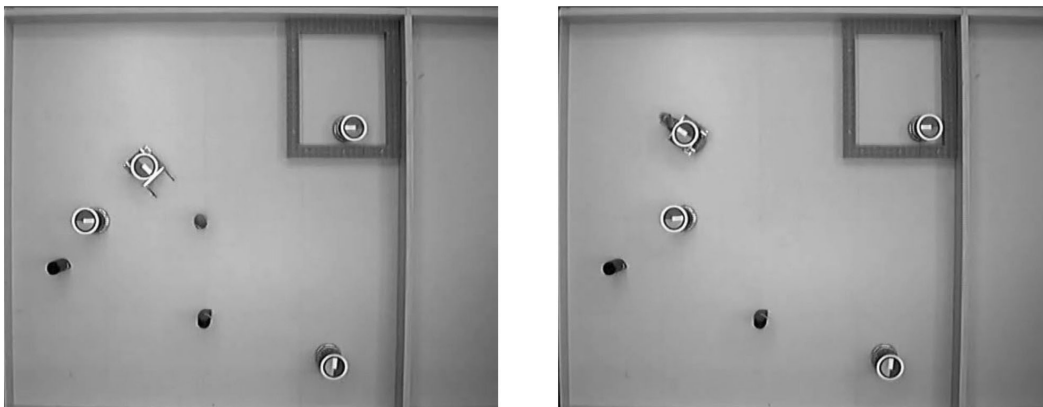
Abbildung 6-6. Nach der Entdeckung des ersten Zylinders lokalisiert der Kameraroboter den Greifroboter und nutzt dessen Transportdienst, da er selbst keine Zylinder transportieren kann.
