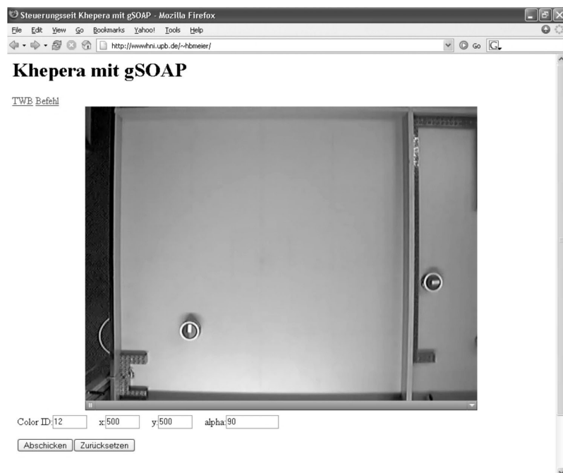
Abbildung 6-16. Ein Foto der allein aus der Dienstbeschreibung des Roboters erstellten (in diesem Beispiel Web-Browser-basierten) Benutzeroberfläche. Hiermit kann der Roboter angewiesen werden, beliebige durch den Benutzer bestimmte Positionen auf dem Operationstisch anzufahren.
