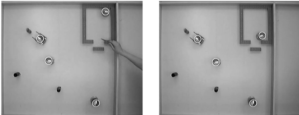
Abbildung 6-7. Der Kameraroboter sucht weiter nach Zylindern. Von außen wird ein Schaden im Mauerwerk nachgestellt, der vom Patrouillenroboter entdeckt wird.
