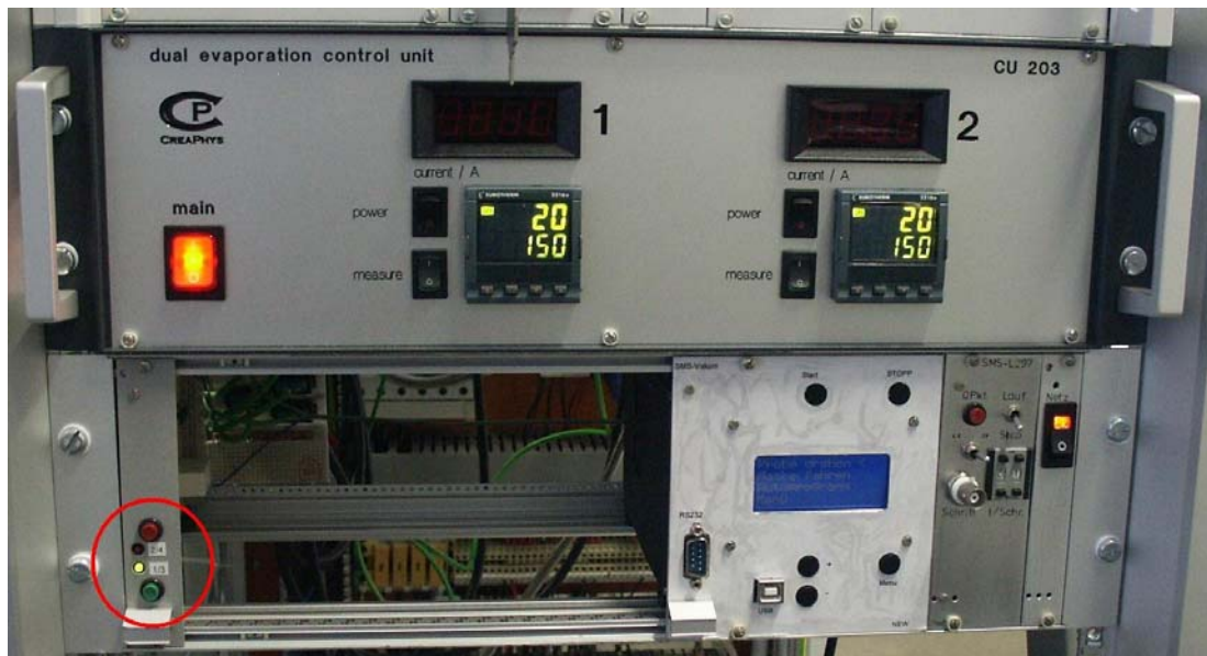
Abbildung 5.3 Steuereinheit CU 203 zur Ansteuerung zweier Verdampferquellen; Die unteren Displays zeigen die gewünschte (hier 150 °C) und die aktuelle Temperatur (20 °C) an. An den oberen Displays ist beim Aufheizen der aktuelle Heizstrom abzulesen. Im rot markierten Bereich sind die Knöpfe zur Auswahl der anzusteuernenden Quellen zu sehen.
