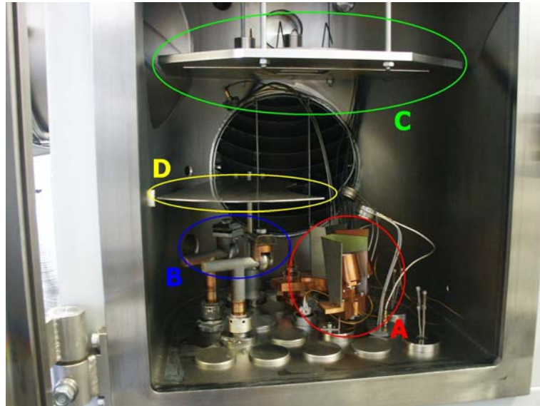
Abbildung 5.1 Rezipient der HV-Anlage Classic 500 ; A: Verdampferquellen für organische Substanzen, B: Metallverdampfer, C: Probenhalter, D: Shutter.
