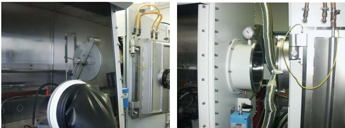
Abbildung 5.10 Links: Blick auf die Glovebox-Schleusentür zur HV-Anlage; Rechts: Verbindung zwischen Glovebox und HV-Anlage.
