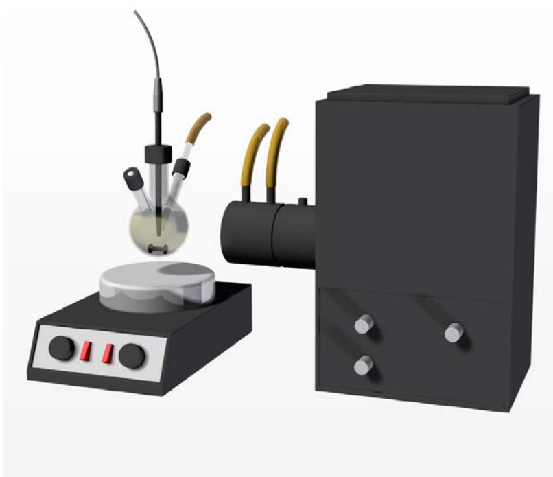
Abbildung 5.10: Schematischer Aufbau der verwendeten Apparatur für den photokatalytischen Abbau
