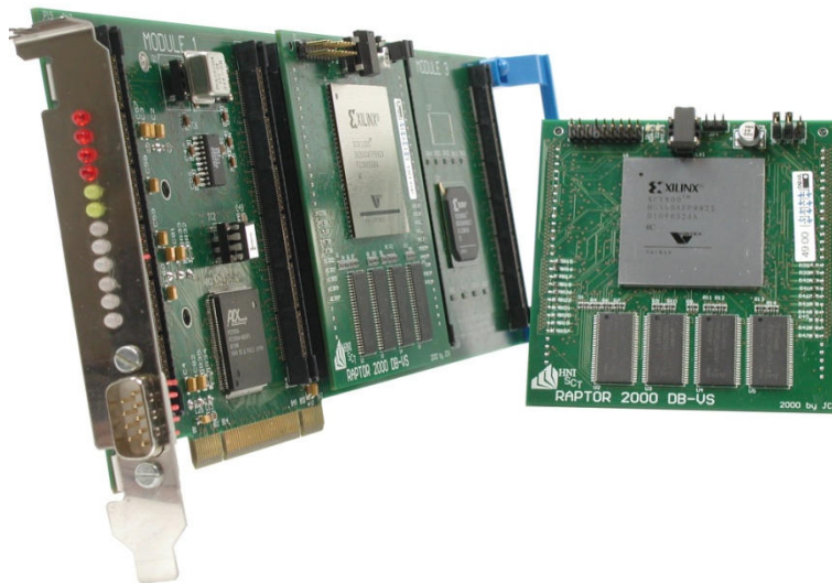
Abbildung 5-8: FPGA-basiertes Rapid-Prototyping-System RAPTOR2000 zur schnellen Systememulation
