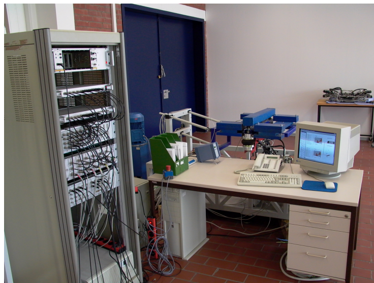
Abbildung 2.28: Hardware-in-the-Loop: Feder-Neigetechnik-Prüfstand der Neuen Bahntechnik Paderborn
