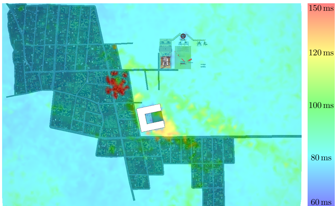
(b) Darstellungsdauer bei 120° Kameraöffnungswinkel
