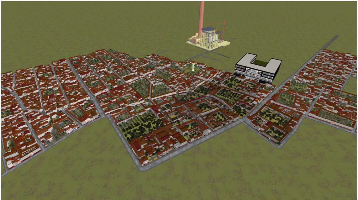
(k) Überblick über die Szene. Regionen, die durch Surfels dargestellt werden (blau in Abbildung (j)), sind generell zu hell. Dies ist deutlich störender als der geometrische Fehler, der durch die Surfels erzeugt wird.
