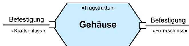
Bild 4-29: Gehäuse als Beispiel einer Tragstruktur
