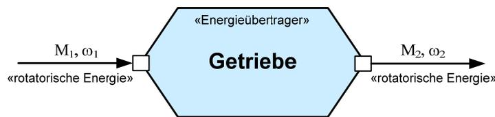
Bild 4-15: Getriebe als Beispiel eines Energieübertragers
