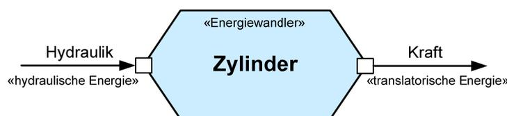
Bild 4-17: Zylinder als Beispiel für einen Energiewandler
