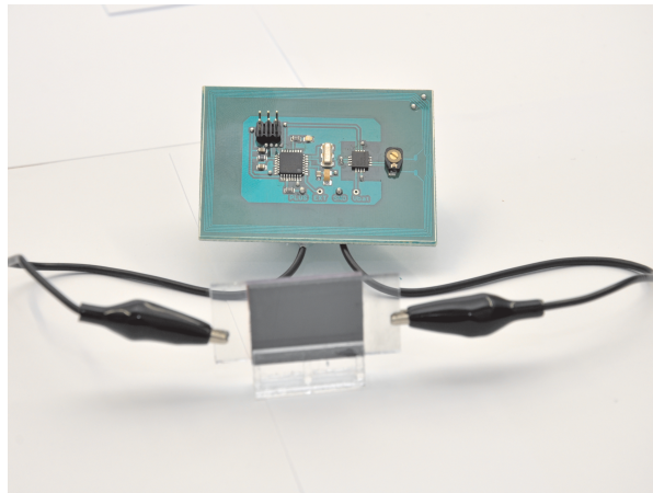
Abbildung 5.7: Bild des Sensorsystems mit RFID-Platine.
