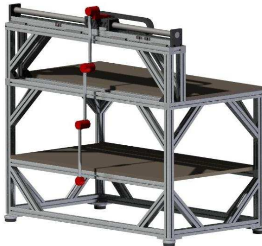
Bild 2-4: Prüfstand des Mehrfachpendels auf einem Wagen (CAD-Zeichnung)
