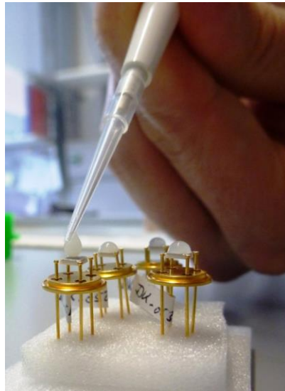
Abbildung 3.1 Präparation der sensitiven Halbleiterschicht auf den kommerziell erhältlichen Sensorsubstraten durch drop-coating .
