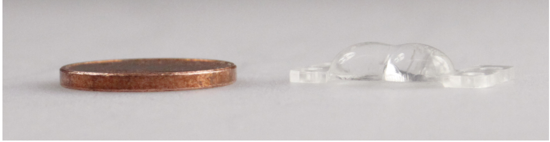
Abb. 1.1: Diese Primäroptik (rechts) erzeugt eine homogene Lichtverteilung auf einem Reflektor, damit dieser ein gleichmäßiges Erscheinungsbild aufweist. Die Form lässt erkennen, dass jedes Beleuchtungsproblem eine eigene Lösung benötigt. Links ist zum Größenvergleich eine 1 Cent Münze abgebildet.
