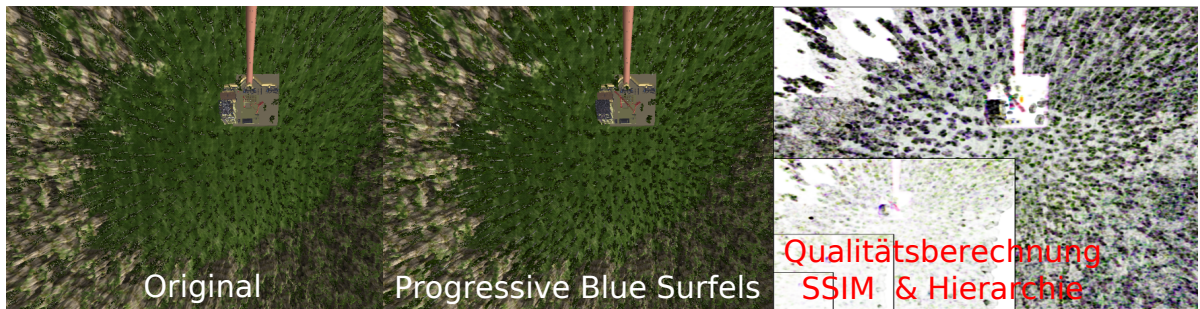
Abbildung 7.5: Beispiel für eine Position mit Bildqualitätswert von 0.85 mit Ausgabe der Qualitätsbewertungsheuristik; minimale und maximale projizierte Größe: [300,400]; Der Fehler ergibt sich hauptsächlich aus der etwas voluminöseren Darstellung der Surfels, wodurch alle Silhouetten leicht gestört werden.
