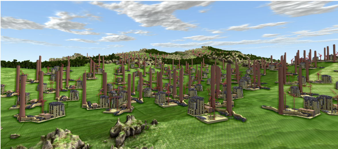
Abbildung 6.1: Beispiel für die Darstellung einer komplexen Szene durch das Progressive-Blue-Surfels-Verfahren. Im Frustum befinden sich ca. 5.8 Milliarden Dreiecke, verteilt auf ca. 480 Tausend Szenengraphknoten. Dargestellt werden ca. 14 Millionen Dreiecke und 8 Millionen Punkte mit 11.8 fps.
