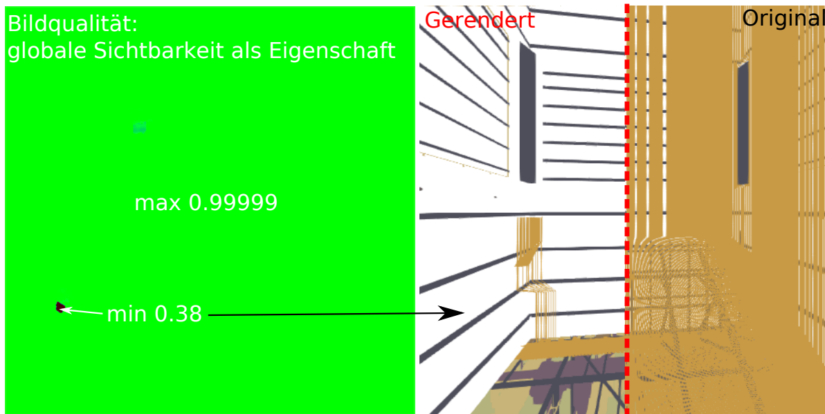
Abbildung 7.11: Bildqualität des globalen Sichtbarkeitsverfahrens (hierarchisches SSIM): (links) visuelle Darstellung mit minimalen und maximalen Werten; (rechts) Gerendertes Beispielbild und Original aus einer Position mit minimaler Bildqualität
