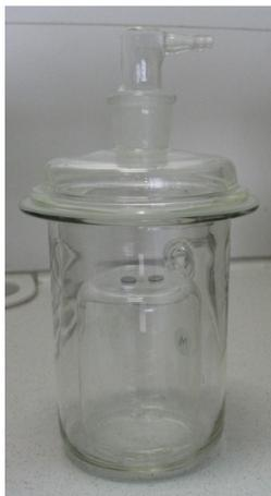
Im Anschluss an die Trifluoressigsäureanhydrid-Derivatisierung wurde das KTL-beschichtete Blech in einen Exsiccator auf ein umgedrehtes Becherglas gelegt. Auf den Exsiccatorboden wurden mit einem Glasrichter 5 – 10 ml 25%-ige wässrige Ammoniaklösung zugegeben. Der Exsiccator wurde abgedeckt, wobei eine Öffnung im Deckel dem Druckausgleich diente. Nach einer Reaktionszeit von 15 Minuten wurde das KTL-Blech entnommen.
