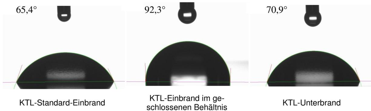
**Abbildung 31:** Liegende Wassertropfen auf den im Labor eingebrannten KTL-Blechen. Die Konturlinie, die Basislinie und der Kontaktwinkel des Tropfens sind eingezeichnet.
