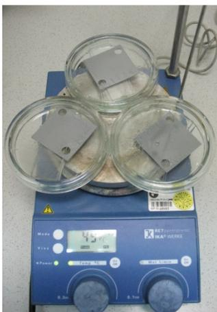
Ein KTL-beschichtetes Blech der Abmessungen 4,5 cm × 4,5 cm wurde in einer Petrischale aus Glas auf fünf Objektträger gelegt. Die Glasschale wurde auf eine 45 °C-temperierte Heizplatte gestellt. Nach Zugabe von 1 – 2 ml Pentafluorbenzaldehyd auf den Gefäßboden wurde die Petrischale abgedeckt. Nach einer Reaktionszeit von zwei Stunden wurde das KTL-Blech entnommen.
