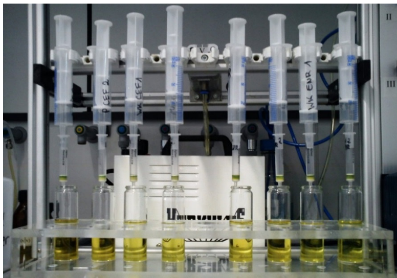
Abbildung 49: OPI-SPE-System bestehend aus Kompressor, Pumpe, Spritzen, Kartuschen und Auffanggefäße
