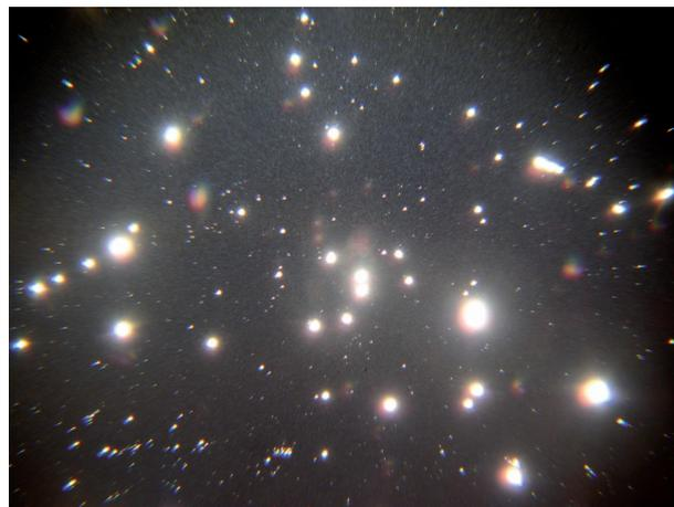
Abbildung 5.16.: Durchlichtmikroskopaufnahme von Pin-Holes in einer 200 nm dicken Titanschicht bei 100-facher Vergrößerung
