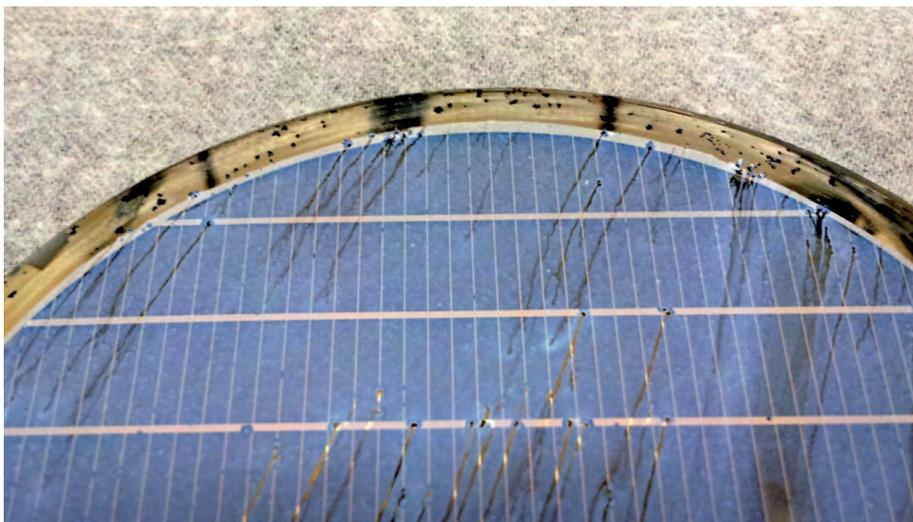
Abbildung 4.10.: Defekte in der Struktur und der  $\text{TiO}_2$ -Schicht direkt nach der Beschichtung mit Hilfe der Suspension
