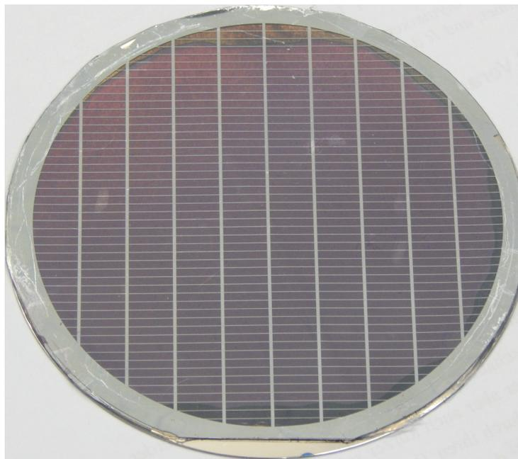
Abbildung 4.6.: Farbstoffsolarzelle mit einer Busstruktur vom Typ 4
