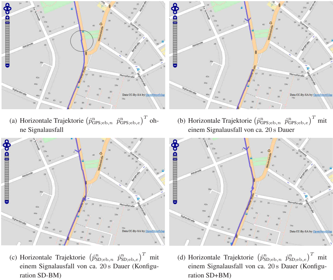
Abbildung 9.5: Auswirkungen eines GPS-Signalausfalls auf das vollständige Navigationsfilter (Bild-daten von OpenStreetMap , veröffentlicht unter Lizenz CC-BY-SA 2.0)
