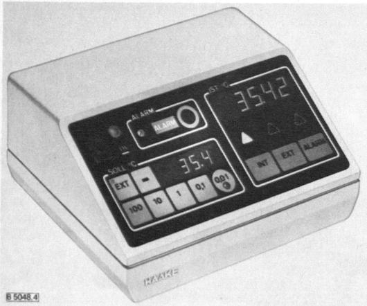
Abb. 4. Kontroll- und Bedienungseinheit für Laborthermostaten der neuen Baureihe N4-T von *Haake*; links: Feld zur Einstellung der Soll-Temperatur; rechts: Feld zur Abfrage der Ist-Temperatur im Bad (INT) oder in einem Zusatzgefäß (EXT); außerdem: Abfragemöglichkeit der eingestellten Grenztemperatur (ALARM). (*Haake GmbH & Co.*, Karlsruhe)
