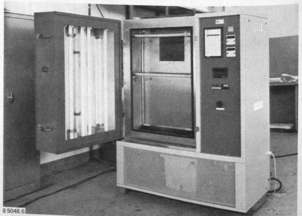
Abb. 6. Global-UV-Test-Gerät, System *Weiss-Bauart BAM*, für Kurzzeitprüfung der Licht- und Wetterbeständigkeit organischer Stoffe. (*Weiss Technik GmbH*, Reiskirchen)
