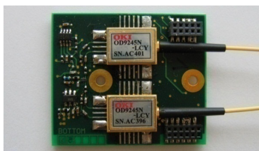
Abbildung 18: Aufgebauter Interferenzdetektor des Typs „spannungslinear 1“ als Aufsteckplatine, Detektion in beiden Polarisationskanälen.
