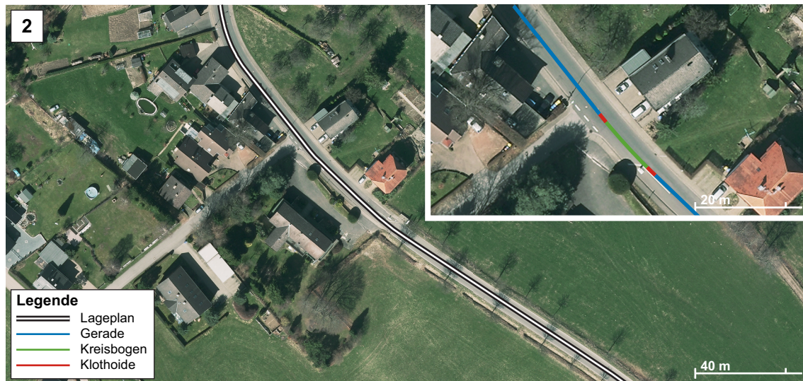
Bild 5-3: Streckenabschnitte unterschiedlichen Maßstabs mit manuell definiertem Lageplan.
