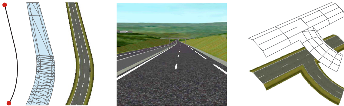
Bild 3-4: Generierung des Graphikmodells von Straßen, Einschnitten bzw. Aufschüttungen sowie Kreuzungen nach CARLES [Car01, S. 95], [Car01, S. 100] [Car01, S. 126].
