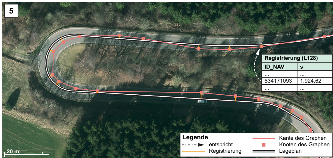
Bild 5-5: Streckenabschnitt mit der Registrierung zwischen Lageplan und Navigationsdaten.
