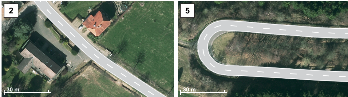
Bild 5-6: Generierte Fahrbahnen einzelner Streckenabschnitte vor dem Hintergrund des digitalen Orthophotos.
