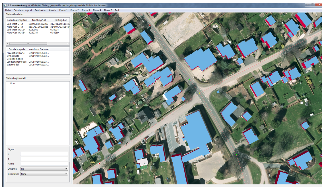
Bild 4-26: Integrierte Darstellung der importierten Geodaten am Beispiel von 3D-Stadtmodell, Navigationsdaten und Orthophoto.
