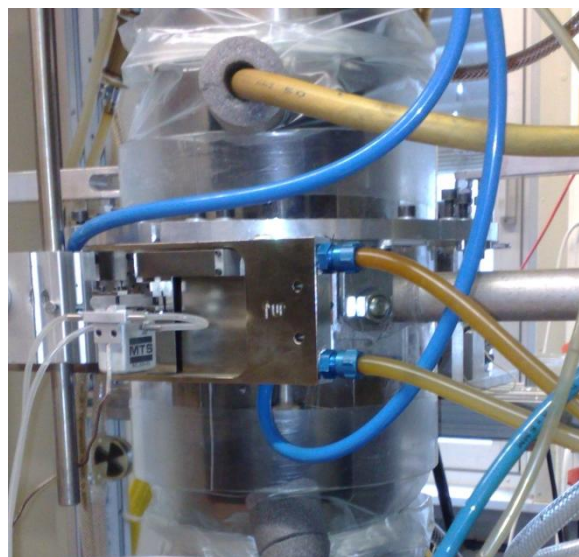
Abbildung 3.11 Ausschnitt aus dem Arbeitsraum des modifizierten Belastungsdilatometers.
