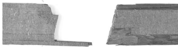
Abbildung 4-18: Versagensverhalten bei unidirektionalem CFK-1a mit Fasern in Zugrichtung
