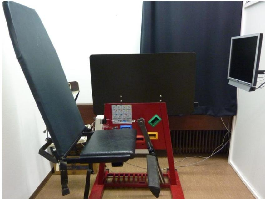
**Abbildung 5: Messplatz zur Überprüfung der Winkelreproduktion und der isometrischen Maximalkraft**
