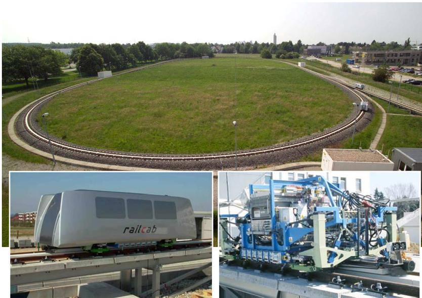
Abbildung 6.1: Versuchsanlage Neue Bahntechnik Paderborn / RailCab im Maßstab 1:2,5 an der Universität Paderborn sowie Versuchsfahrzeuge (RailCab) Gesamtlänge 530m (Quelle: [ADG+09])
