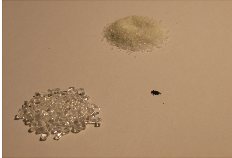
Abb. 3.6. Vergleich der unbehandelten Extrusionsrohstoffe mit dem konditionierten Pulvergemisch. Dieses Gemisch (oben) erscheint aufgrund der vielen zusätzlichen lichtbrechenden Schnittkanten trüb, während das PMMA-Granulat (unten links) noch vollständig klar ist. Die MWNT (mitte rechts) sind zugunsten der Sichtbarkeit in stark überhöhtem Massenverhältnis dargestellt.
