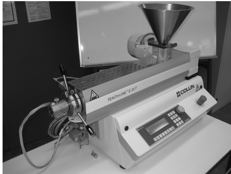
Abb. 3.4. Das fertig montierte Extrusionssystem mit Extruder, Werkzeug und Werkzeugheizband, sowie integrierter Steuerung.
