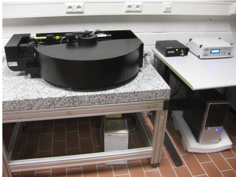
Abb. 3.10. Aufbau des verwendeten Goniometers mit allen Zubehörgeräten. Das komplette Messinstrument steht auf einer massiven Granitplatte, die durch Moosgummi schwingungsdämpfend vom Tischgestell getrennt ist.
