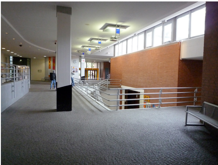
Abb. 6.24 Das Tageslicht beleuchtet den unter- en Zugang zu den Hörsälen, allerdings ist dieser Bereich reine Verteilfläche und hat keine repräsentative Funktion. Die Betonung durch das Tageslicht löst beim Nutzer die Erwartung aus, dass es sich um einen zentralen Bereich handelt, was aber nicht der Fall ist. Die Säulen stehen im Laufweg und verdecken Informa- tionen am Ende des Ganges, die für den Nutzer möglicherweise von Interesse sind.
