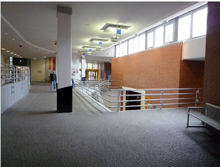
Abb. 1.7 Das Tageslicht beleuchtet den unteren Zugang zu den Hörsälen, allerdings ist dieser Bereich reine Verteilfläche und hat keine repräsentative Funktion. Die Betonung durch das Tageslicht löst beim Nutzer vermutlich die Erwartung aus, dass es sich um einen zentralen Bereich handelt, was aber nicht der Fall ist. Die Säulen stehen im Laufweg und verdecken Informationen am Ende des Ganges, die für den Nutzer möglicherweise von Interesse sind.
