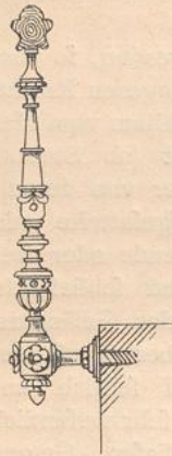
Geländerstab mit Krücke. \frac{1}{20} w. Gr.
